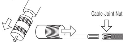
**8.** Unscrew the cable-joint nut.
